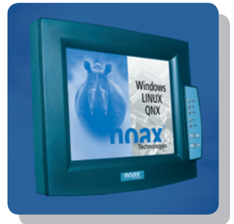
Komplett geschlossenes Gehäuse - IP65
